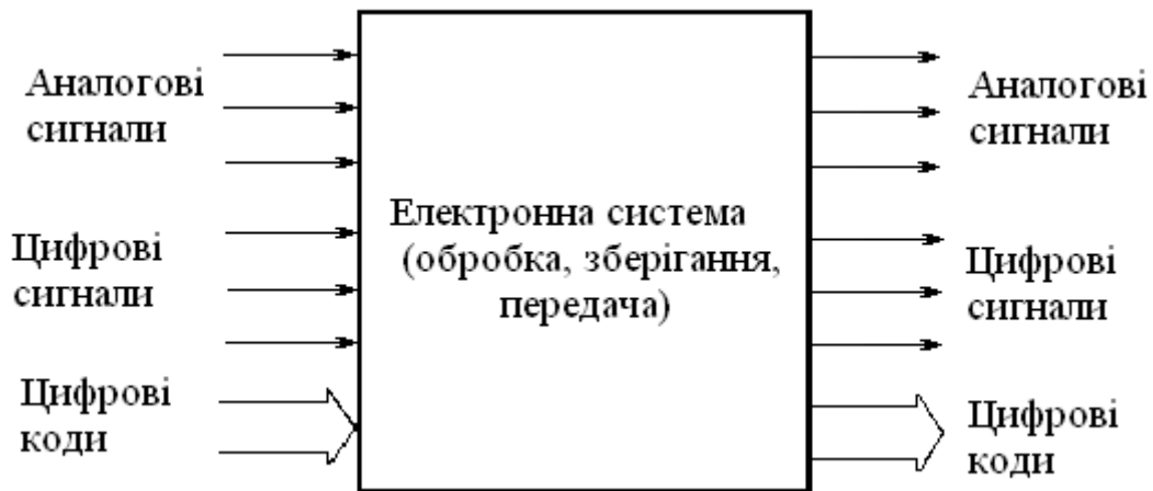
Рисунок 1.1 – Узагальнена схема електронної системи як чорний ящик
