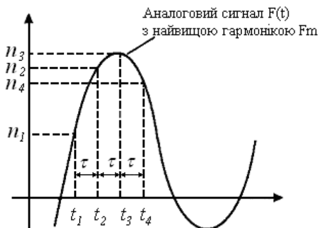
Рисунок 3.7 – Амплітудна модуляція неперервного сигналу
