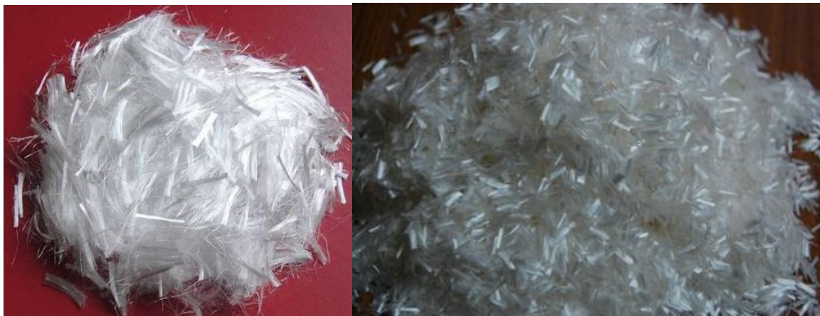
Рисунок 2 – Поліпропіленова фібра з різними розмірами волокон
