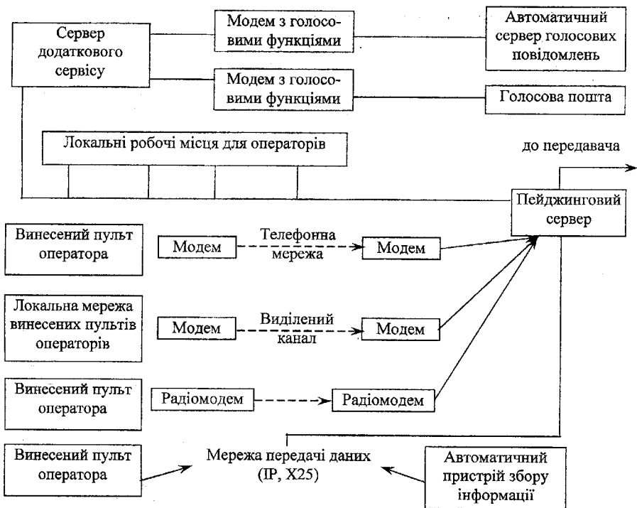
Рисунок 8.7 - Склад устаткування пейджингової системи
