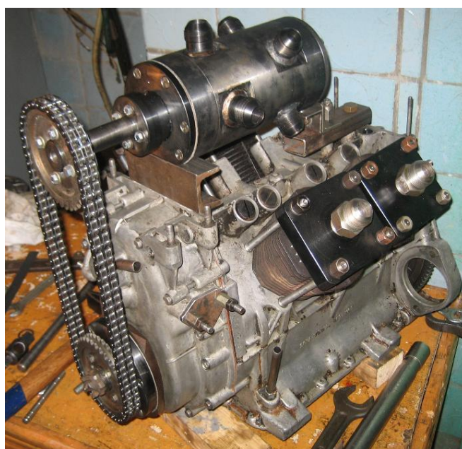
Рис 3. – Пневмодвигун з золотниковим повітророзподільником
