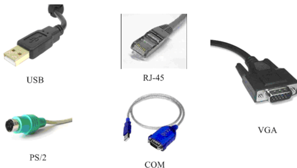
Рисунок 1.2 – Основні типи штекерів для підключення периферійних засобів
