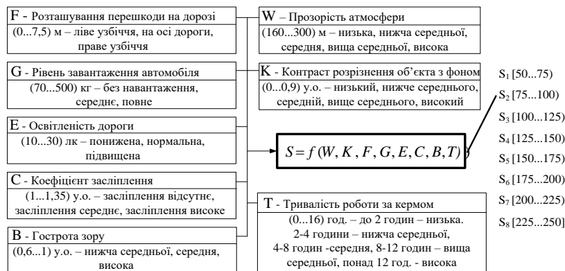
Рис. 1. Структура моделі визначення дальності видимості (фактори впливу, універсальна множина, терми для їх оцінок)
