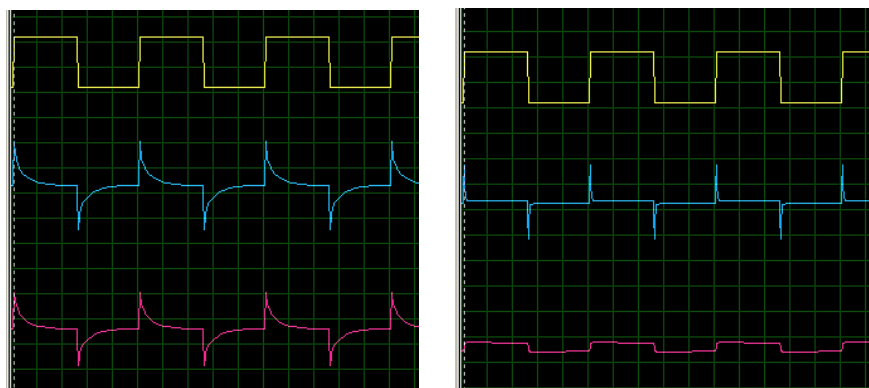
Рис. 2. Осцилограми тестування працездатності імпульсного трансформатора (сигнал генератора імпульсів, сигнал на I-й та II-й обмотці трансформатора): а) трансформатор справний, б) трансформатор має замкнуті витки
