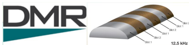
Рисунок 1 - Структура TDMA радіоінтерфейсу стандарту DMR.
