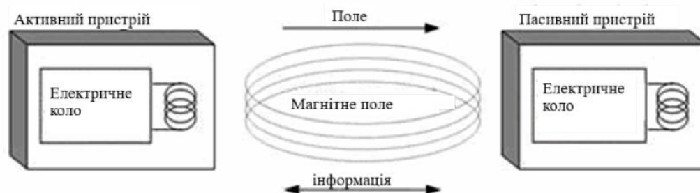
Рисунок 1 – Принцип обміну інформацією за технологією NFC
