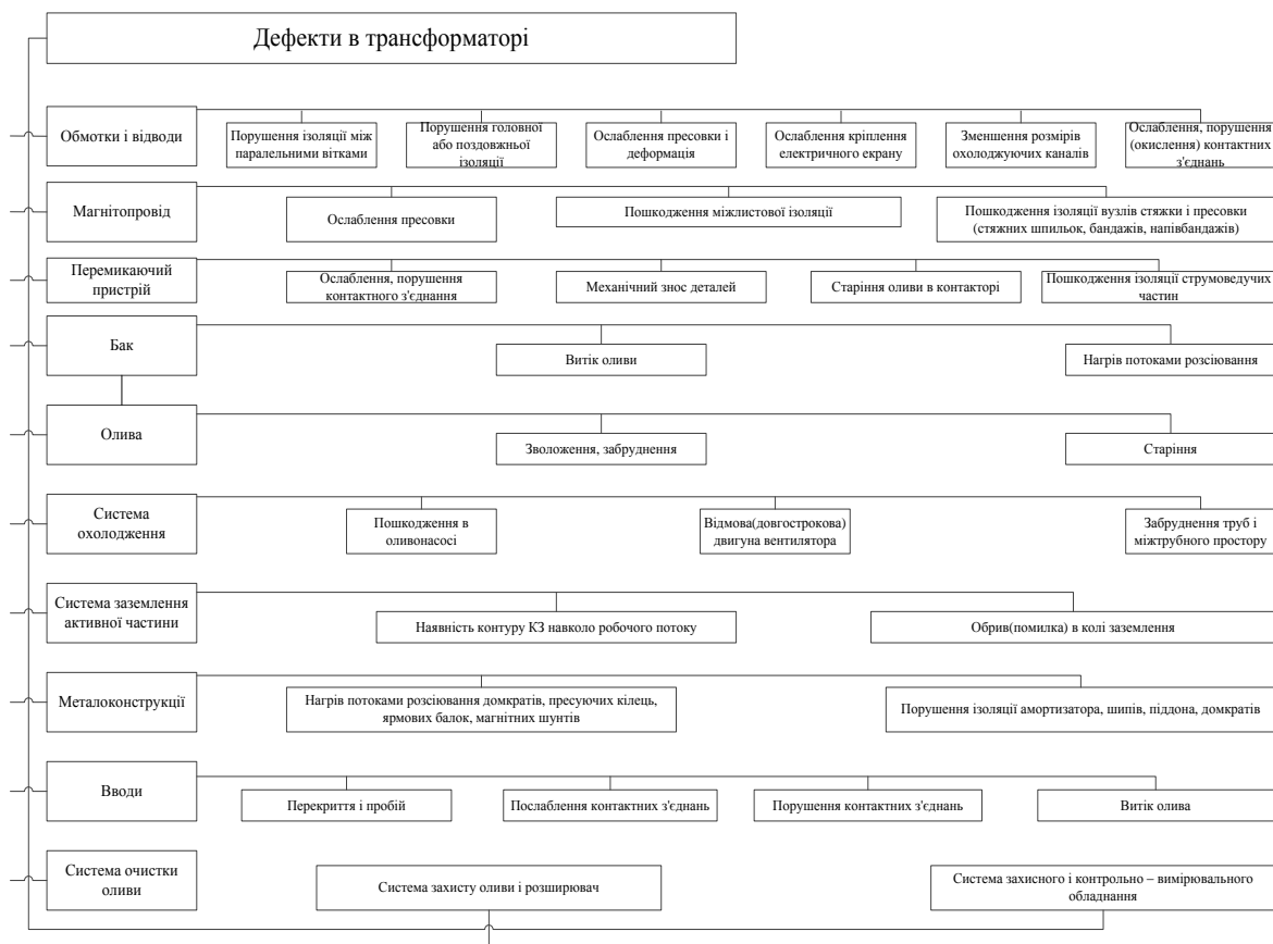
Рис.1 - Узагальнена система класифікації дефектів силових трансформаторів
