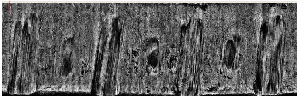
Рис. Сліди на кулях, вистрілених з патронів, що мали різні заряди пороху. а — повний заряд; б — 1/2 заряду; в — 1/4 заряду.
