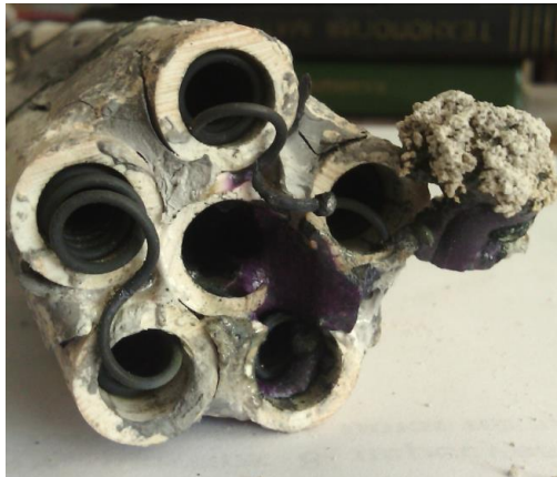
Рисунок 4 – Загальний вигляд перегорілої спіралі діаметром 1 мм.
