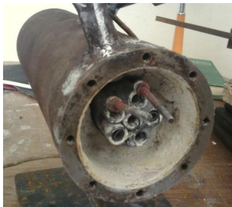
Рисунок 3 – Газодинамічний напилювальний пристрій з вмонтованим нагрівачем.
