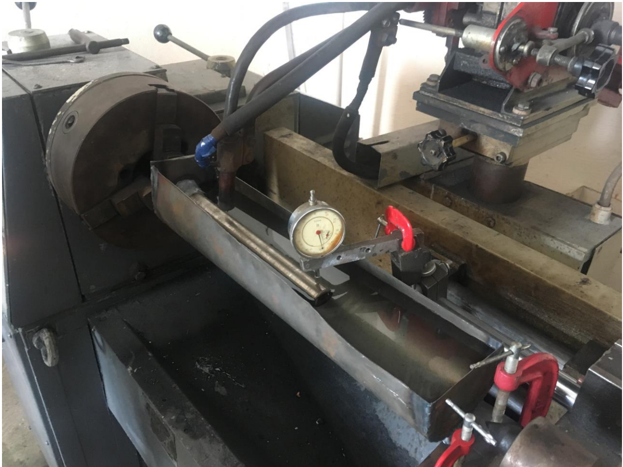
Рис.1. Установка для мокрого наплавлення.
