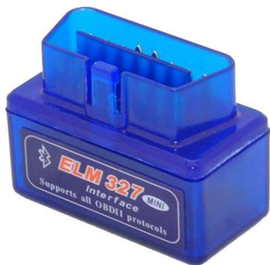
Рис. 1. Модуль сканера "ELM327"
