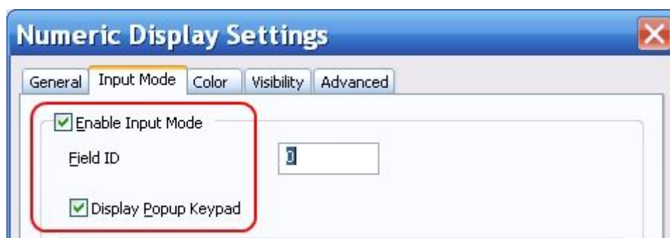
Настройки графического элемента Numeric Display для точного ввода заданной скорости
