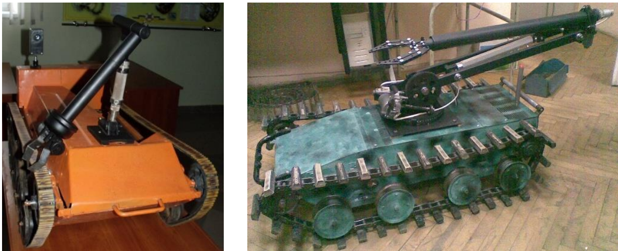
Рисунок 2 – Експериментальні прототипи роботів для розмінування
