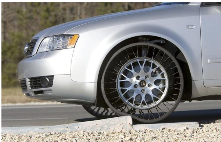
Рисунок 1 – Тестування шин tweel на автомобілі Audi a4
