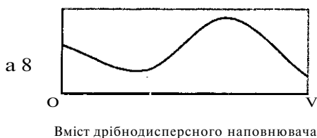
Рис. 2. Узагальнений хвилеподібний характер залежності міцності дисперснонаповнених композиційних матеріалів від концентрації наповнювача
