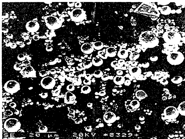
Рис. 1. Частинки золи-виносу (збільшення у 1000 разів)
