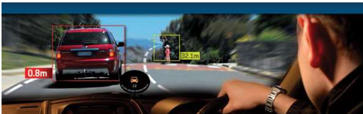
Рисунок 2 – Інтелектуальна система запобігання аварійним ситуаціям Mobileye C2-270
