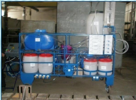
Експериментальний стенд з виготовлення мазутової емульсії (за допомогою кавітаційних пристроїв)
