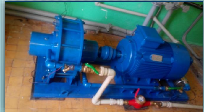
Гідродинамічний кавітаційний теплогенератор (45 кВт)
