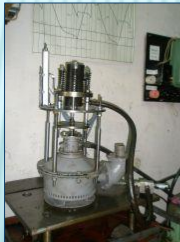
Експериментальний мембранний насос з гідравлічним приводом
