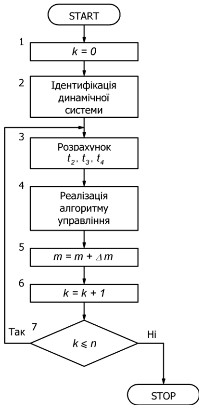
Рисунок 4 – Блок-схема базового алгоритму управління тяговим електро механічним комплексом
