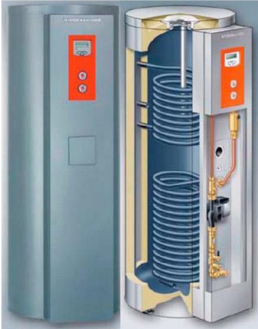
Рисунок 2.8 – Ємнісний водонагрівач Vitocell 100-U працює від двох джерел тепла з вбудованим циркуляційним насосом, змонтований системою труб геліоконтура, арматурою для наповнення, відводом повітря і автоматикою управління Vitosolic 100
