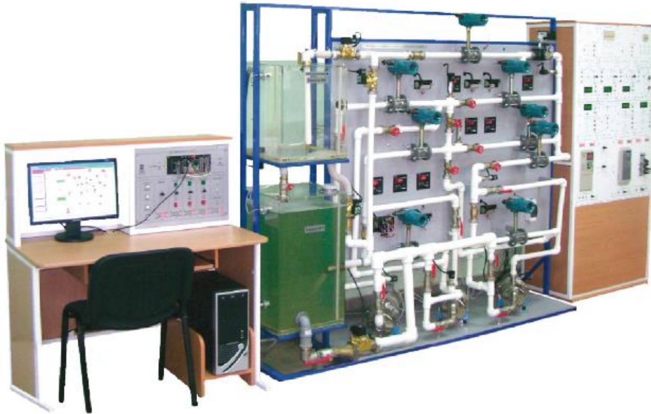
"Система автоматизації перекачувальної насосної станції"
