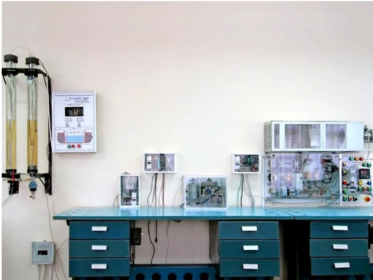
Стенд "Модель шахтного водовідливу"
