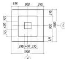
Схема армування фундаменту ФМ-1
