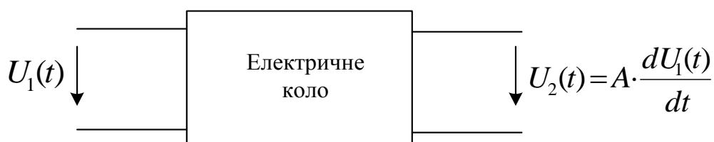
Рисунок 7.1 – Електричне коло, що виконує операцію диференціювання
