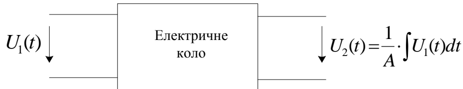
Рисунок 7.7 – Електричне коло, що виконує операцію інтегрування
