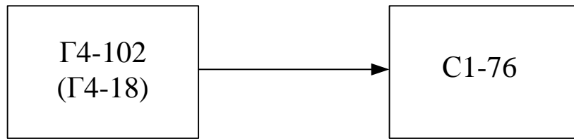
Рисунок 1.3– Схема вимірювання коефіцієнта глибини модуляції амплітудно-модульованого колювання
