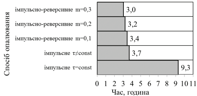
Рис. 2. Залежність тривалості подачі палива з максимальною витратою від способу опалення
