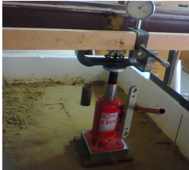
Схема випробування двощілинних фундаментів в лотку
