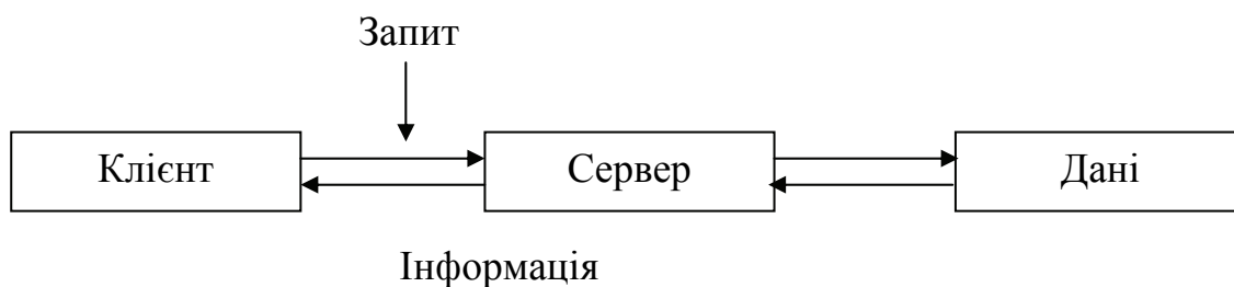
Рисунок 2.13 – Схема взаємодії сервера та клієнта
