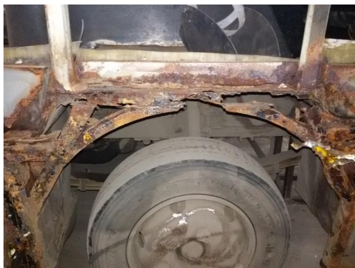
Рисунок 1 – Приклад прояву структурної корозії елементів кузова автобуса «Богдан А-092» 2006 р. випуску
