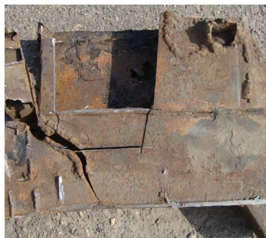
Рисунок 2 – Втомні тріщини лонжеронів каркасу основи профілю 140×60×3 мм автобуса «Богдан А-092» 2006 р. випуску
