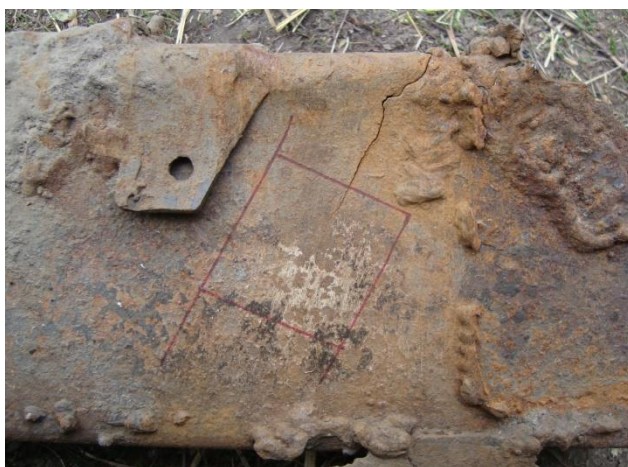
Рисунок 2 – Втомні тріщини лонжеронів каркасу основи профілю 140×60×3 мм автобуса «Богдан А-092» 2006 р. випуску
