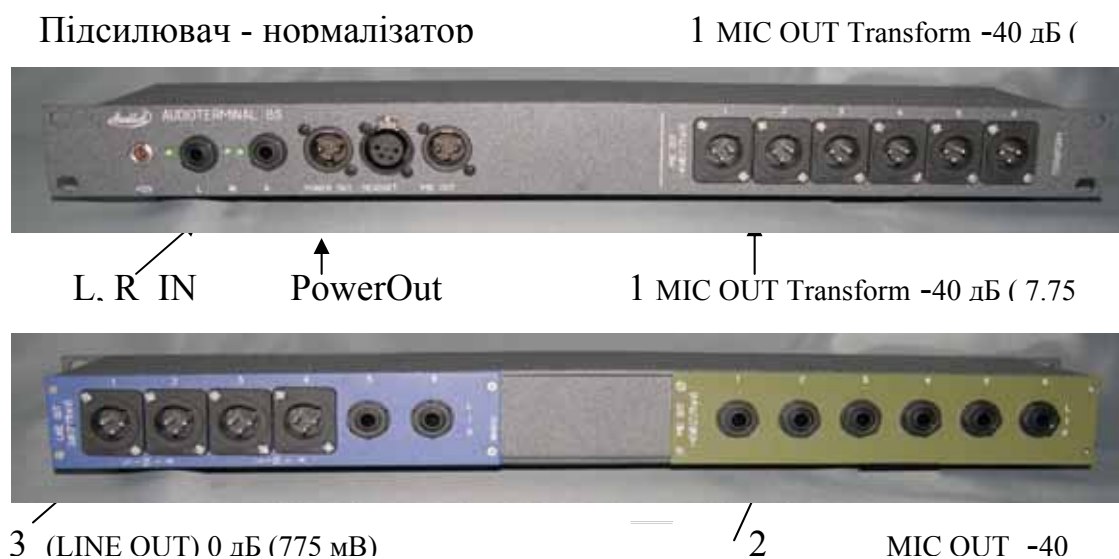
Рисунок 1 - Передня і задня панелі стоїчного терміналу «Audioterminal BS»
