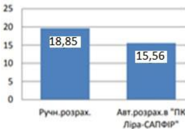
Рис.13. Діаграма площі перерізу арматури для колони
