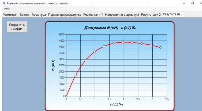
Рис.8. Результаты расчета на 4 стержни «Колона»
