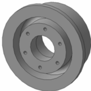
Крок 4. Видавлювання 6-ти отворів M5
