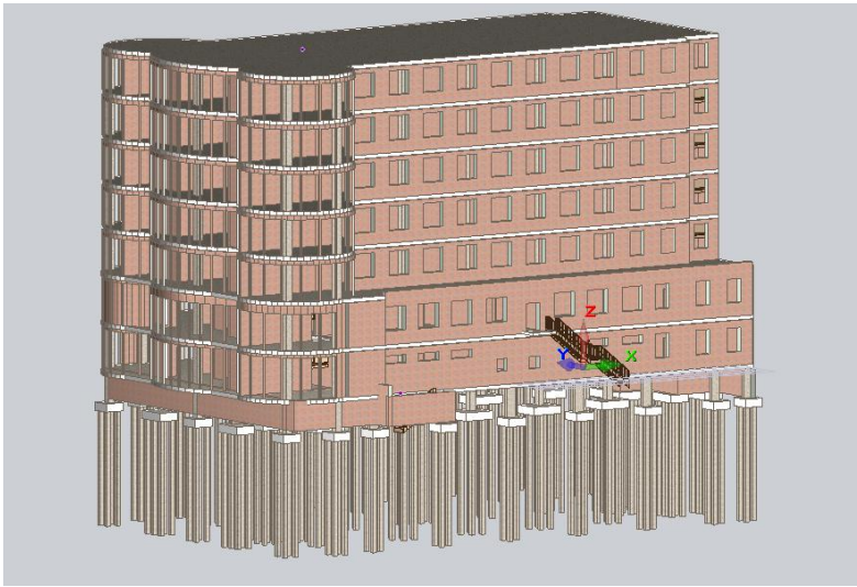
Загальний вигляд моделі будівлі в ПК «САФІР-2015».
