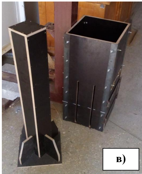
Рисунок 2- Установка для пресування солом'яних тюків а) корпус з прорізами та дверцятами; б) пресувальний шток; в) загальний вигляд.
