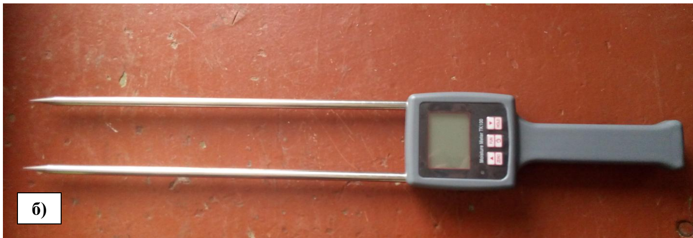
Рисунок 7 – Інструменти та вимірювання вологи а) розпилювач води; б) вологомір ТК100; в) процес виміру вологості в зразку
