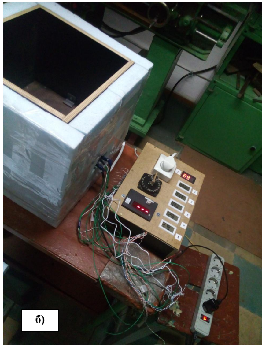
Рисунок 5 – Установка для визначення теплопровідності а) блок автоматичної реєстрації температури (БАРТ) б) загальний вигляд установки
