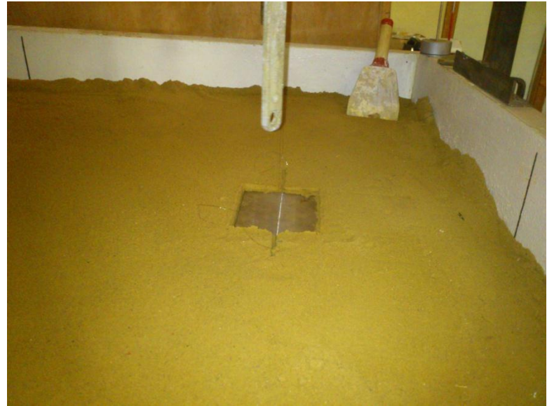
Модель фундаменту 10×10 см на ґрунтовій подушці, що підстиляється плитою
