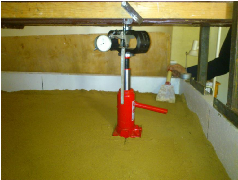
Модель фундаменту 10×10 см на ґрунтовій подушці, що підстиляється плитою
