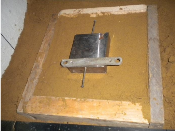
Ґрунтова подушка із щільного піску середньої крупності товщиною 7 см
