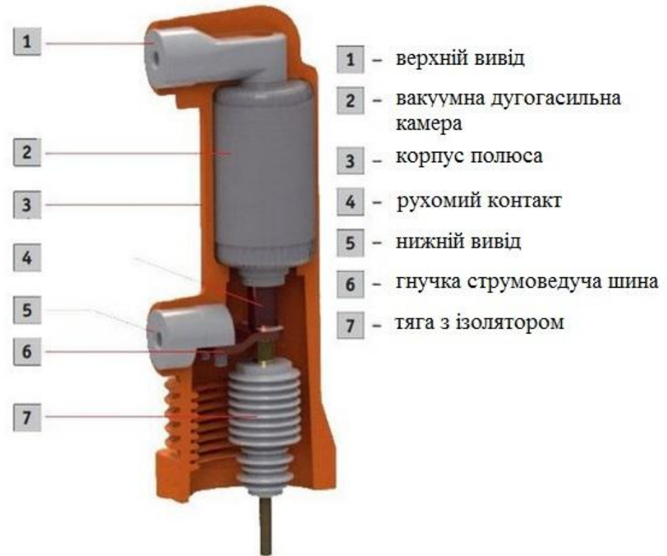
Рисунок 1 – Загальна будова вакуумного вимикача на складі VF12 фірми «Елтехніка»
