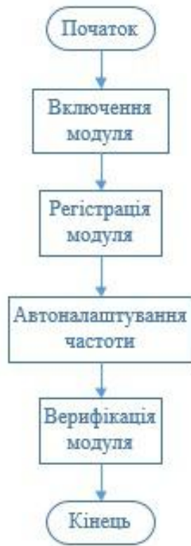
Рисунок 7 – Блок-схема алгоритму виконання програми для GSM модуля (ініціалізація)
