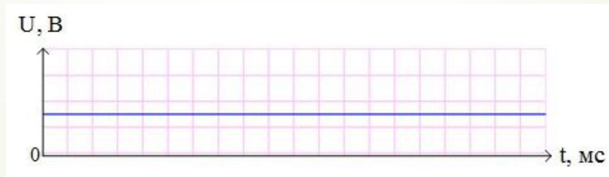
Рисунок 11 – Часова діаграма сигналів з мікрофона
