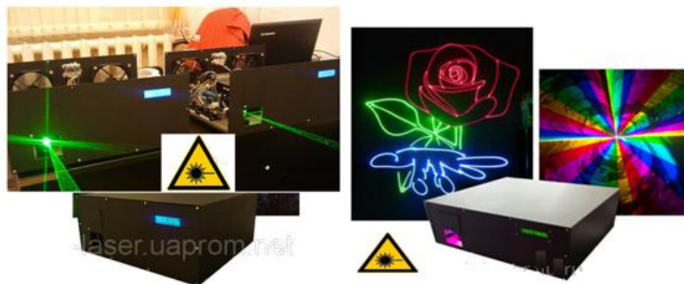
Рисунок 1.12 – ЛСВІ RTG Green 200 Pro T для побудови лазерних зображень реклами
