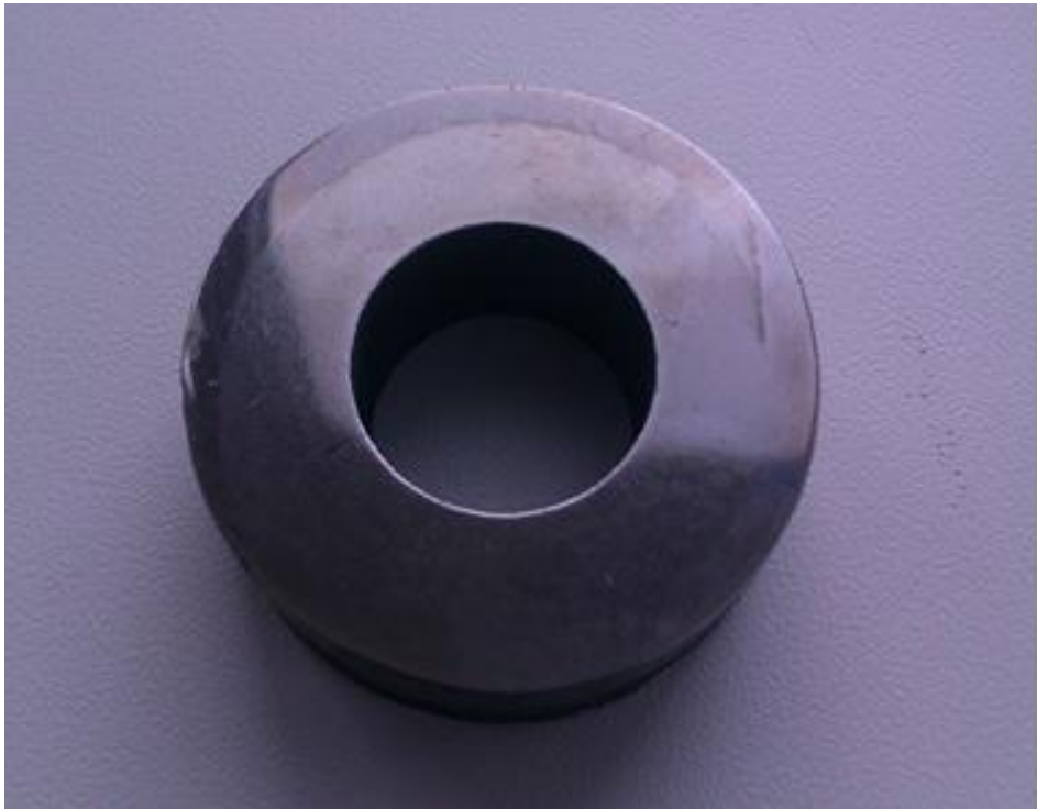
а) Макрошліф сталевого циліндричного зразка після плазмового напилювання
