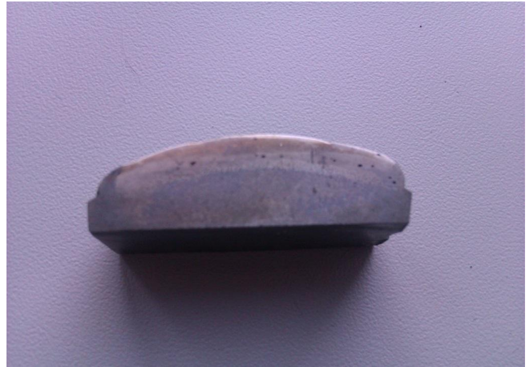
б) Макрошліф сталевого плоского зразка після плазмового напилювання
