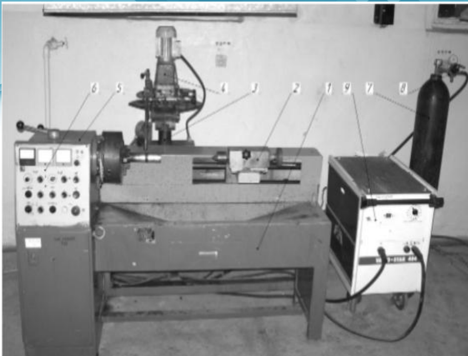
Рисунок (в) – установка для наплавления УД-209М
