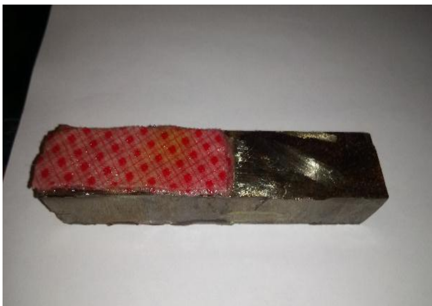
Рисунок (б) - зразок з бавовняною підкладкою
