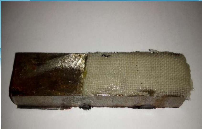
Рисунок (а) – зразок з лляною підкладкою
