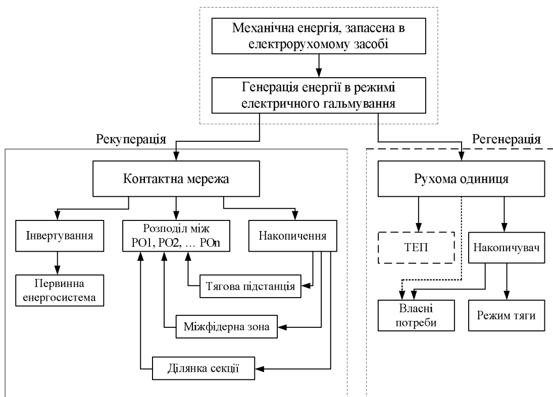
Рис. 1. Розподіл та використання енергії електричного гальмування
