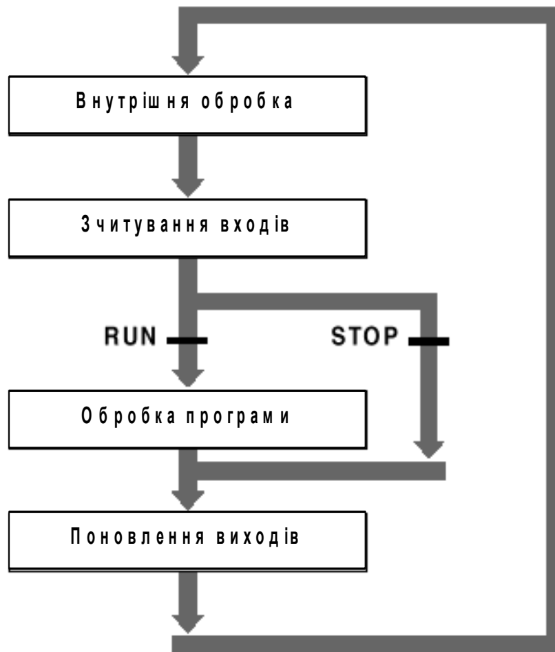
Рисунок 3.8 - Алгоритм роботи ПЛК при циклічному виконанні програми
