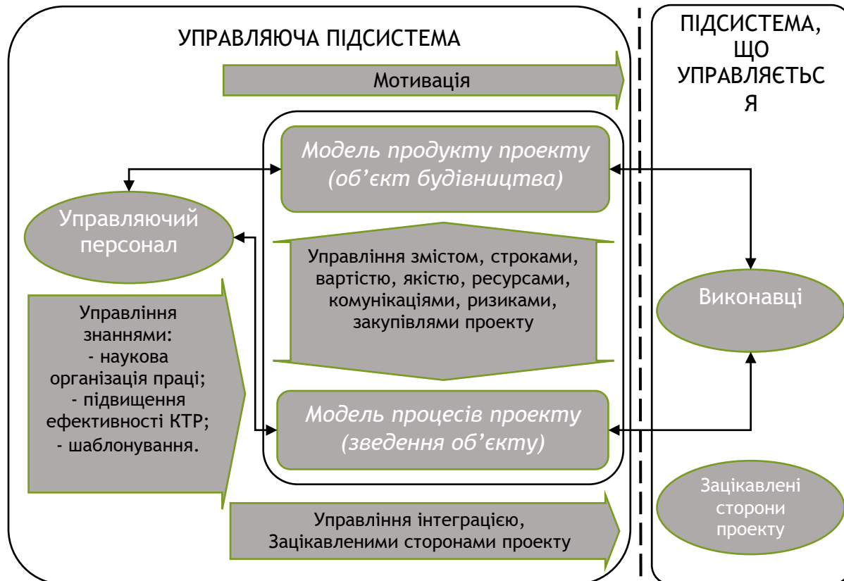
Рис. 2 – Принципова схема використання інформаційних засобів при управлінні у будівництві
