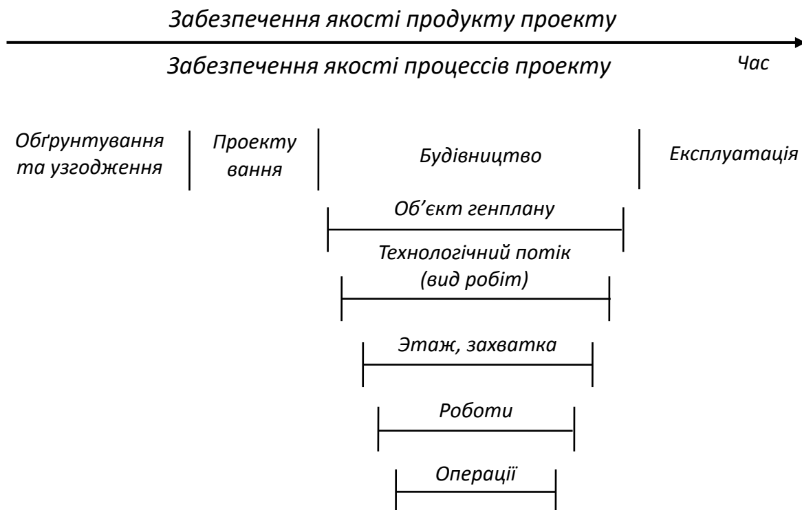
Рис. 1 – Принципова схема деталізації типового інвестиційно-будівельного проекту
