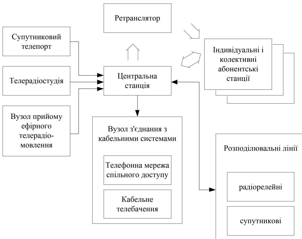
Рисунок 1.2 – Базовий комплекс мікрохвильової телерадіорозподільної мережі
