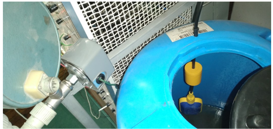
Зовнішній вигляд тієї частини лабораторного станда, де відбувається вимірювання рівня води в накопичувальних ємностях
