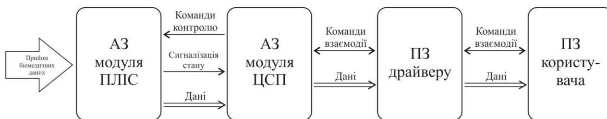
Рис. 9. Схема логічної взаємодії модулів АЗ та ПЗ системи для дослідження периферійного кровообігу, що розробляється
