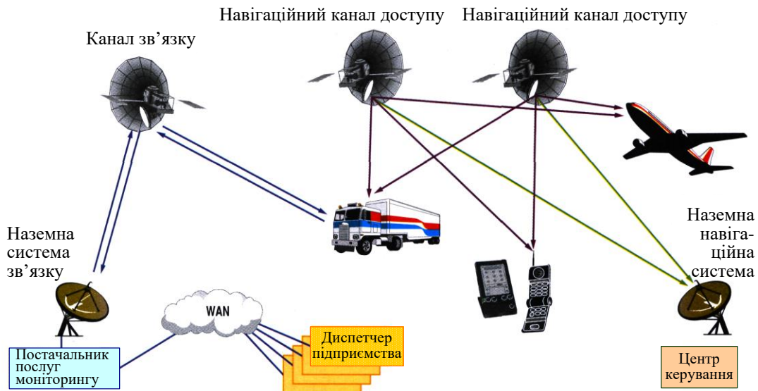
Рисунок 2 – Принцип дії супутникової навігації
