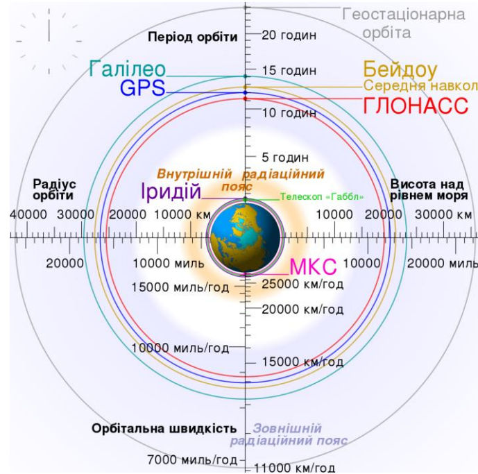
Рисунок 1 – Порівняння геоестаціонарної орбіти, орбіт супутників GPS, ГЛОНАСС, Галілео, Бейдоу та Іридій, Міжнародної космічної станції, космічного телескопу Габбл з радіаційними поясами Ван Аллена та номінальним розміром Землі [3]
