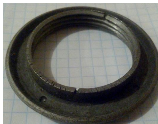
Рисунок 1 – Загальний вид та типові дефекти деталі "Фланець"
