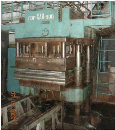
а) б) Рис. 5. Електрогідрравлічний прес "ПЭГ-ХАИ-500": а) загальний вигляд, б) робочий варіант розміщення порожнин багатоелектродного розрядного блоку
